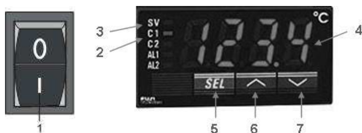
Figura 10: Sección de control de calefactores.
